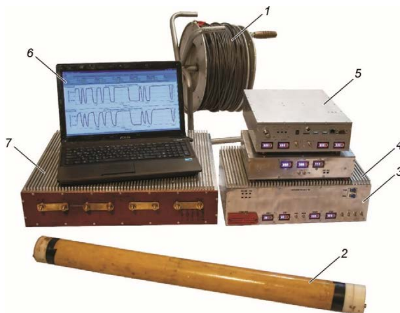
Рисунок 4.1 - Экспериментальный образец измерительного комплекса ЭРК ШПС, внешний вид: 1 – индукционная зондирующая рамка (ИЗР); 2 – индукционный датчик сигналов (ИДС); 3 – генератор зондирующих сигналов (ГЗС); 4 – устройство градуировки (УГ); 5 – блок управления и регистрации сигналов (БУРС); 6 – переносной компьютер (ПК); 7 – блок ограничения тока (БОТ)
